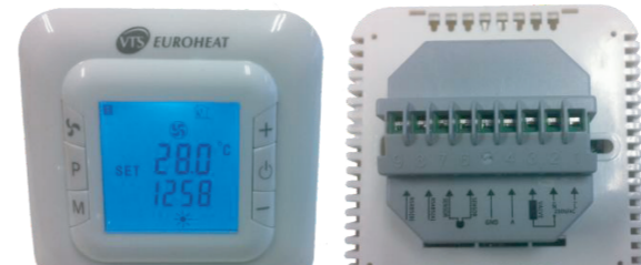
1. Контроллер HMI VR (CTRL. HMI VR 1-4-0101-0169), фото 1
